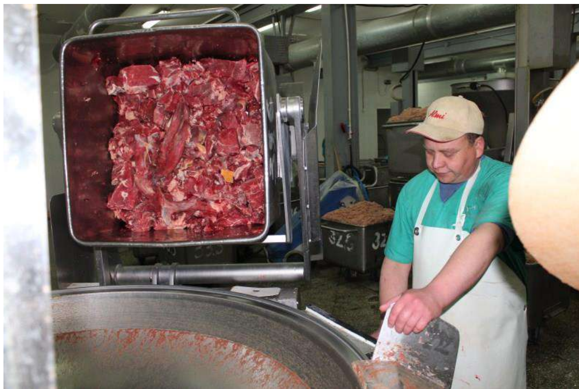
Рис. 9 – Приготовление фарша для фаршевых консервов в куттере
