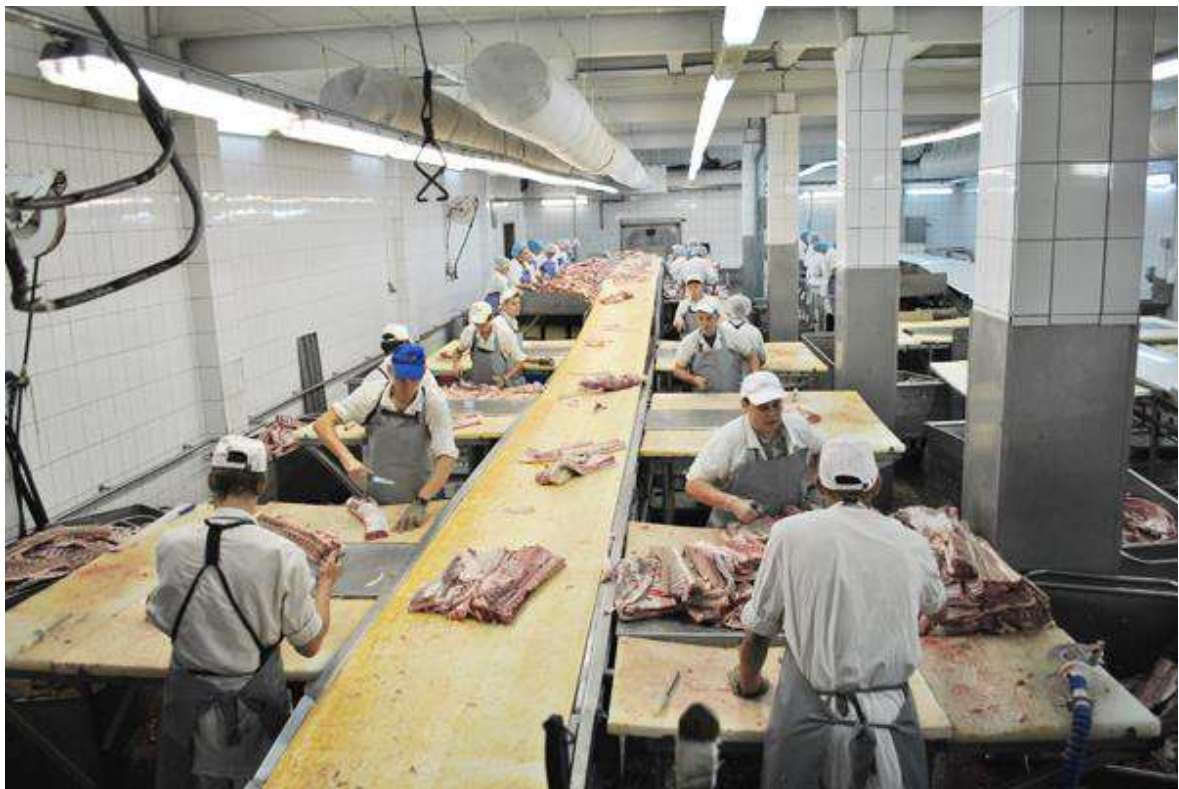
Рис. 4 – Обвалка на конвейерном столе
