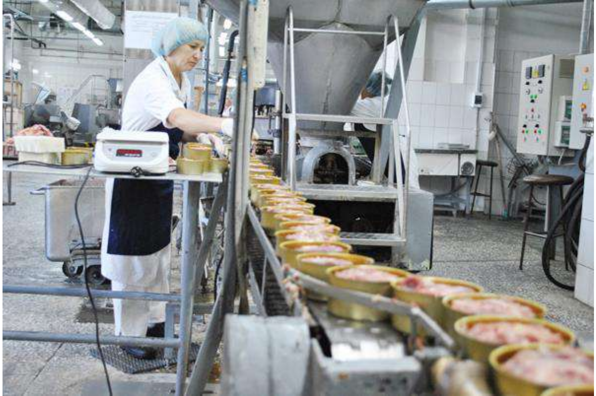
Рис. 18 – Транспортировка консервов на контрольное взвешивание и закатку
