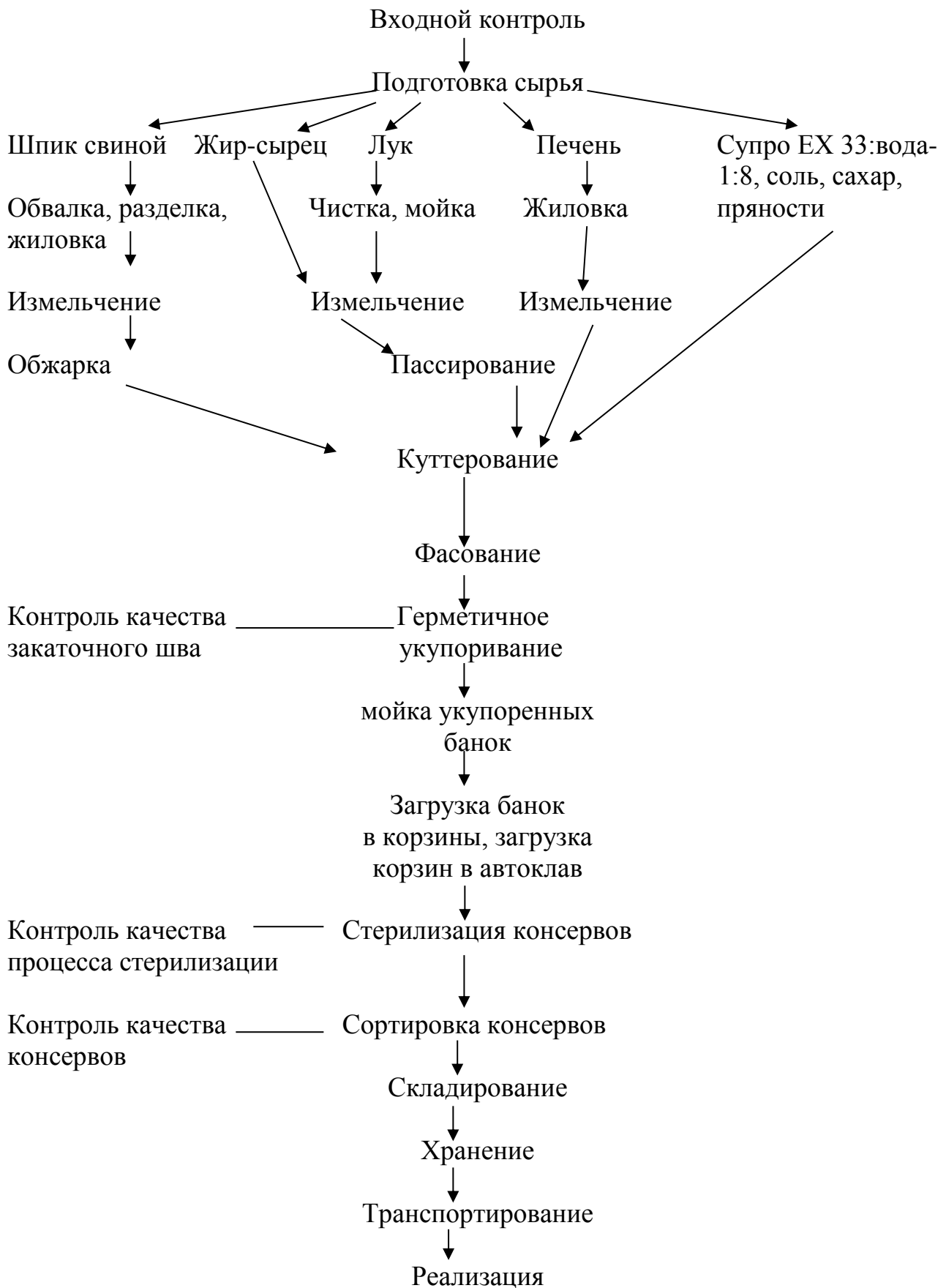
Схема 11 - Технологическая схема производства мясных консервов «Крем любительский»
