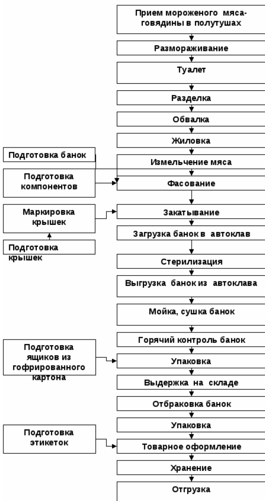
Схема 1 - Технологическая схема производства консервов «Говядина тушеная»
