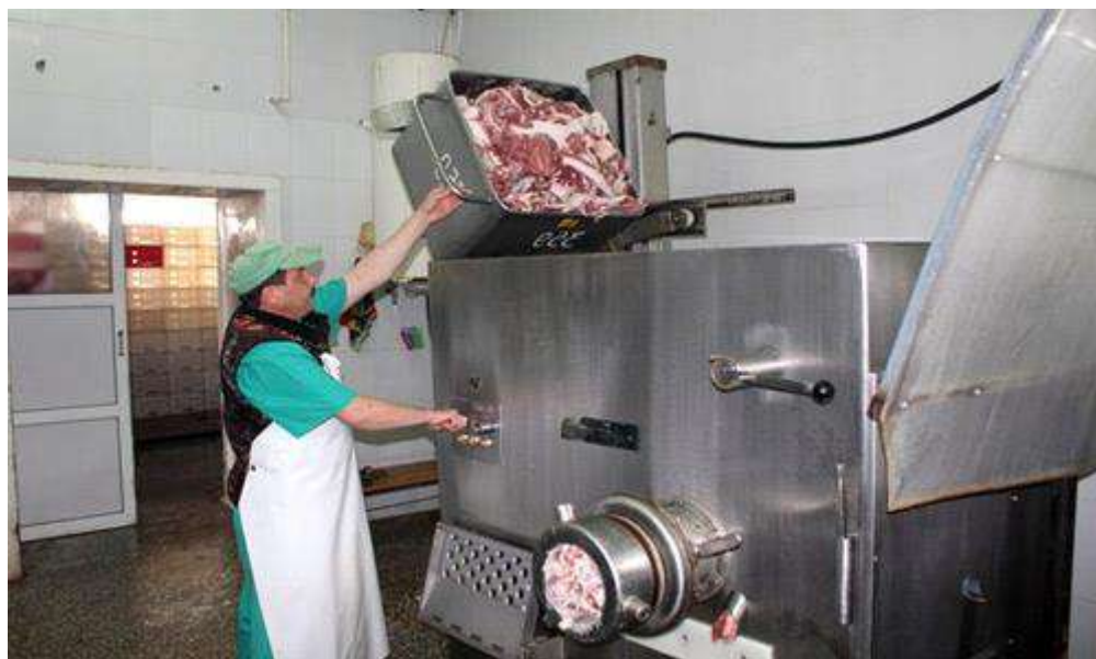
Рис. 8 – Измельчение мясного сырья при производстве фаршевых консервов
