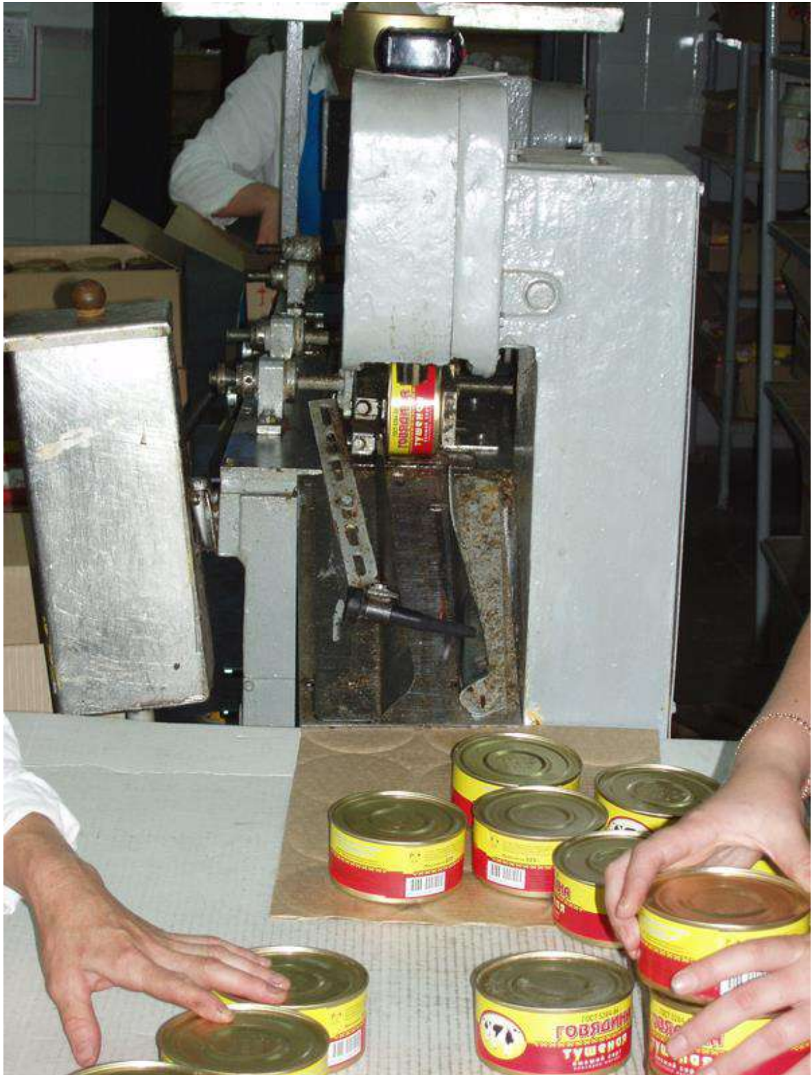
Рис. 19 – Закатка банок и предварительный осмотр
