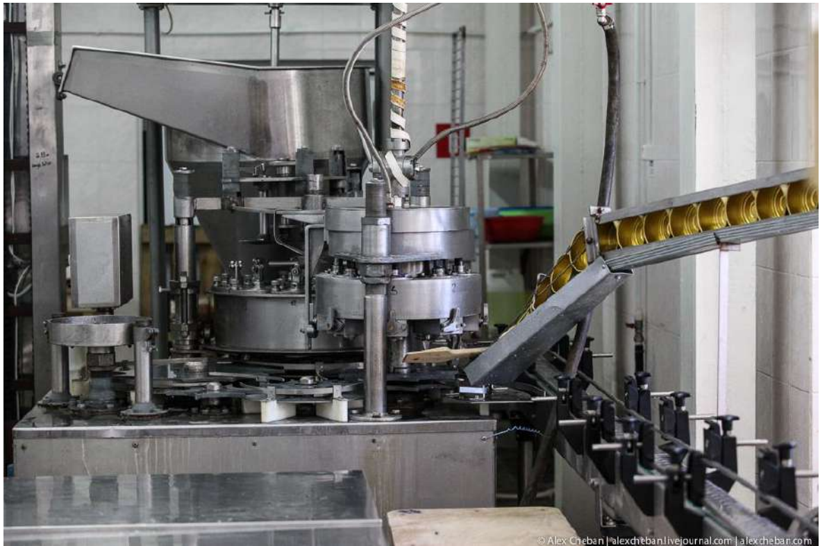
Рис. 15 – Подготовка консервной тары на конвейере перед фасованием
