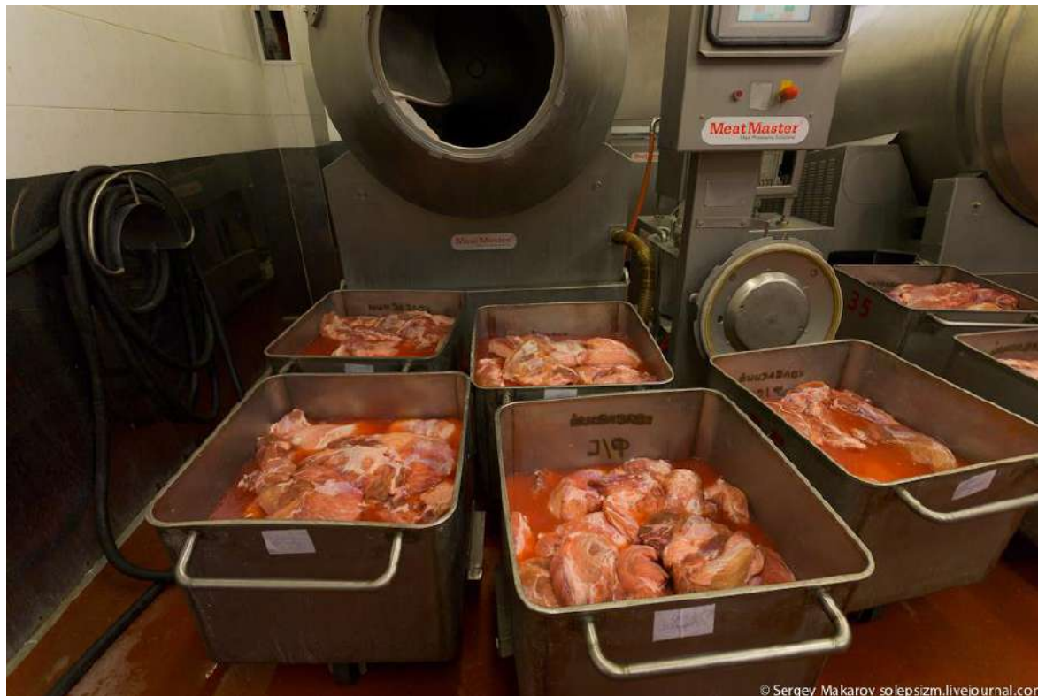
Рис. 12 – Выдержка мяса в рассоле в специализированных тележках
