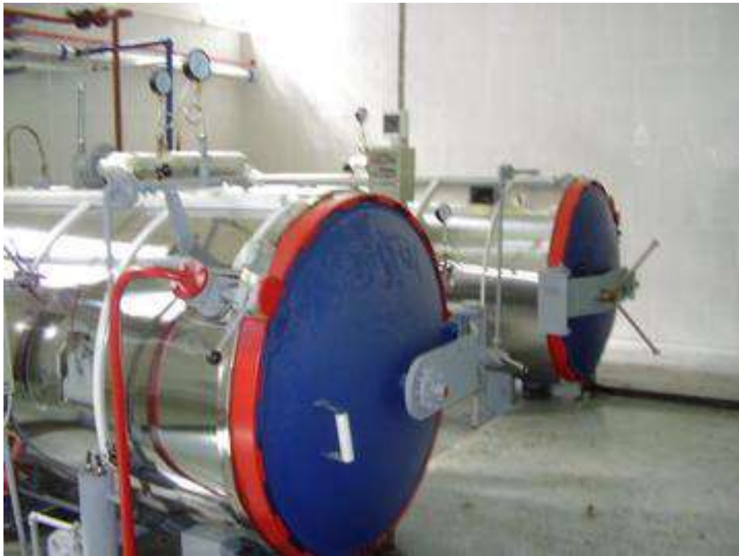
Рис. 20 – Отделение стерилизации консервов с горизонтальными автоклавами
