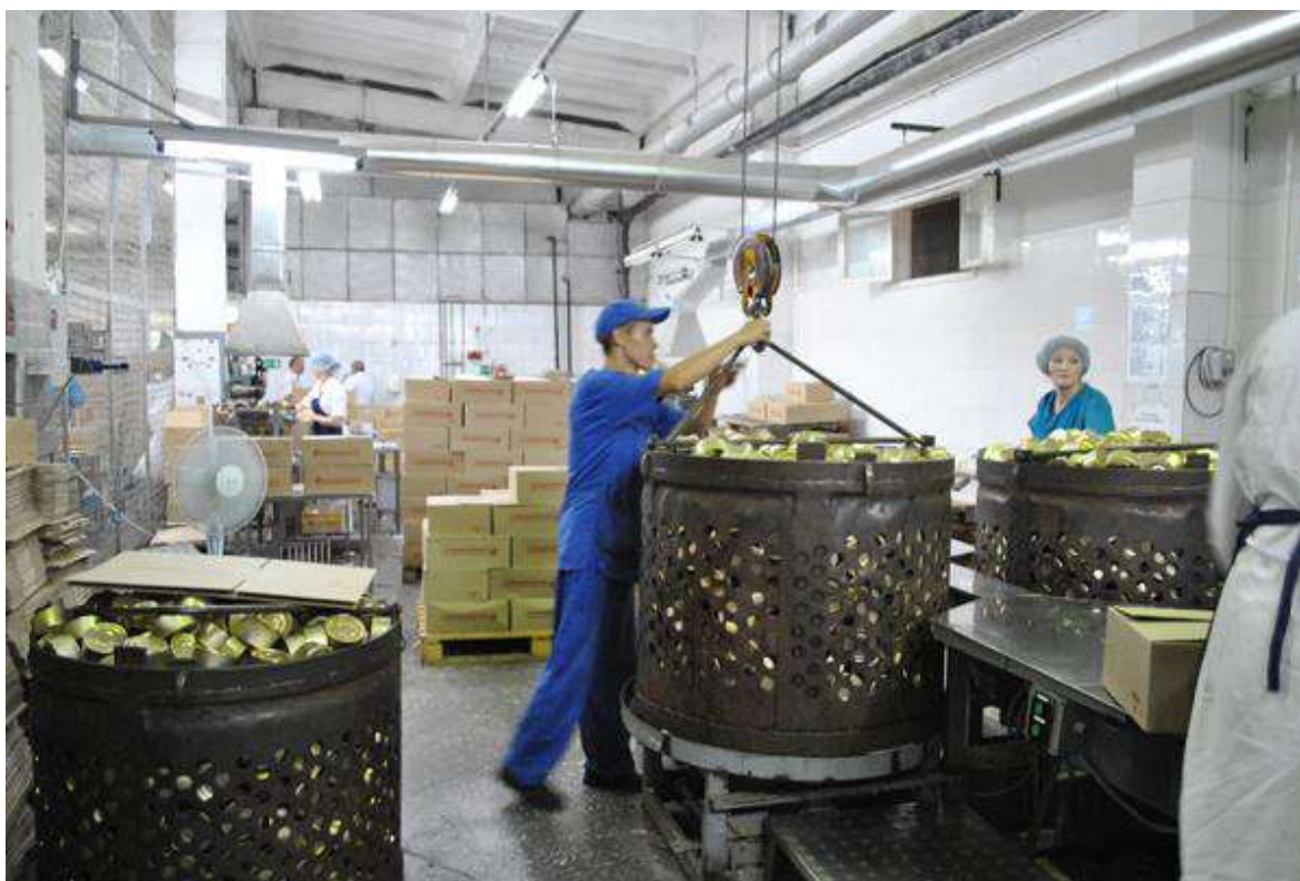
Рис. 21 – Подготовка корзин с консервами для стерилизации
