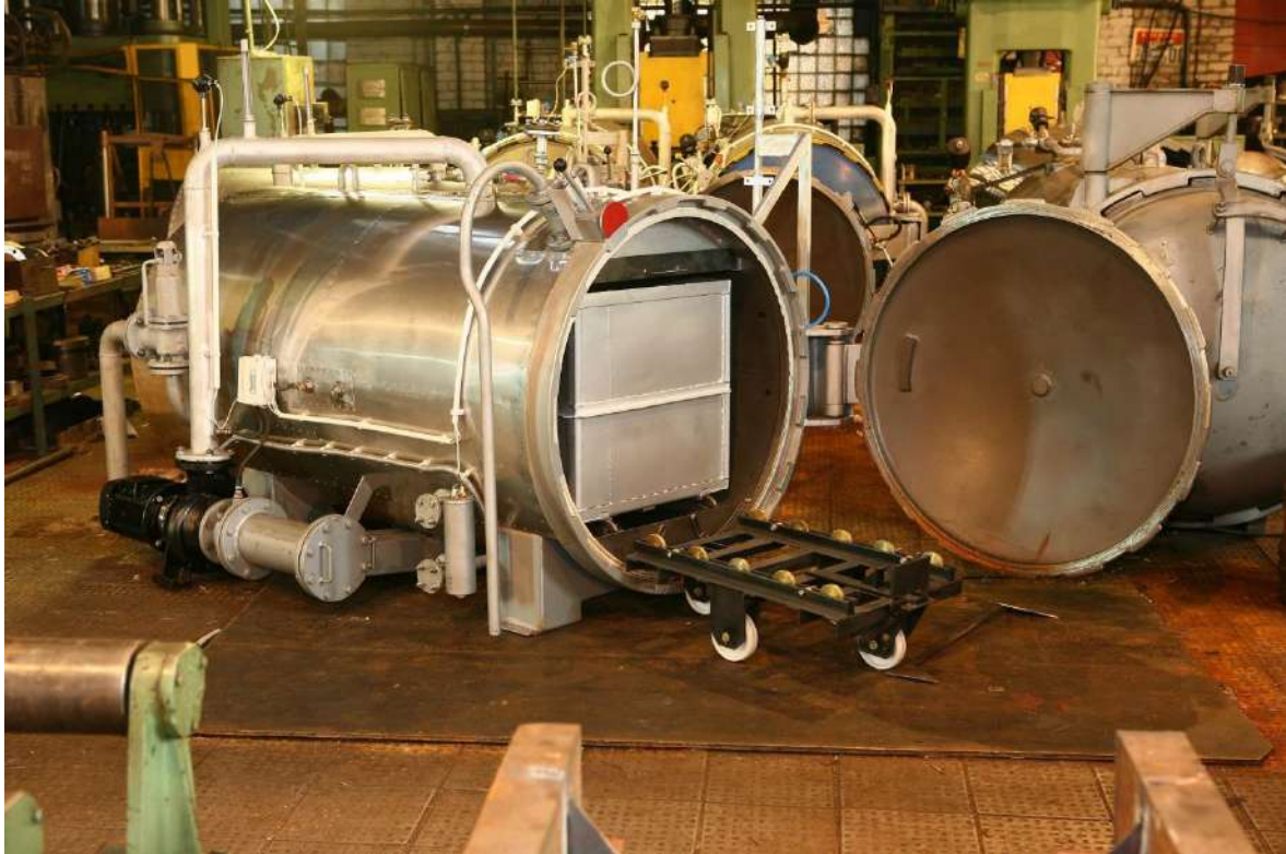
Рис. 22 – Загрузка в горизонтальные вакуумные котлы консервов на стерилизацию
