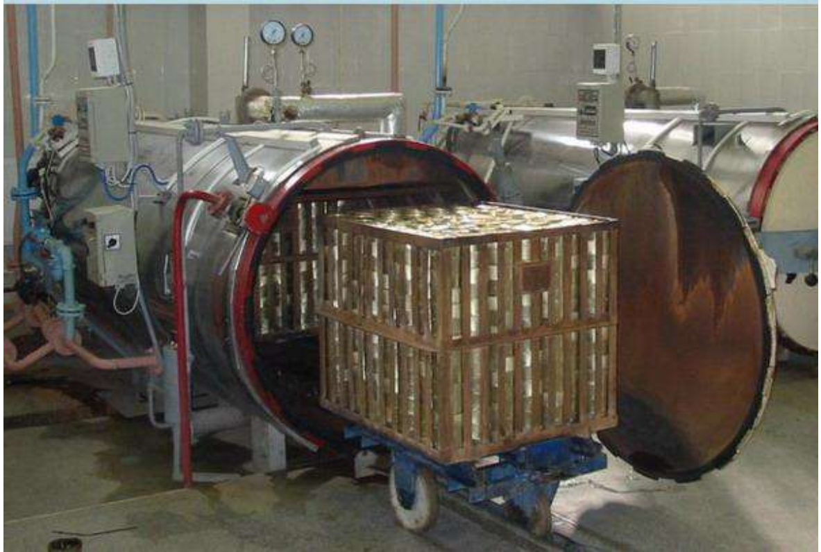
Рис. 24 – Выгрузка из горизонтального вакуумного котла консервов после стерилизации
