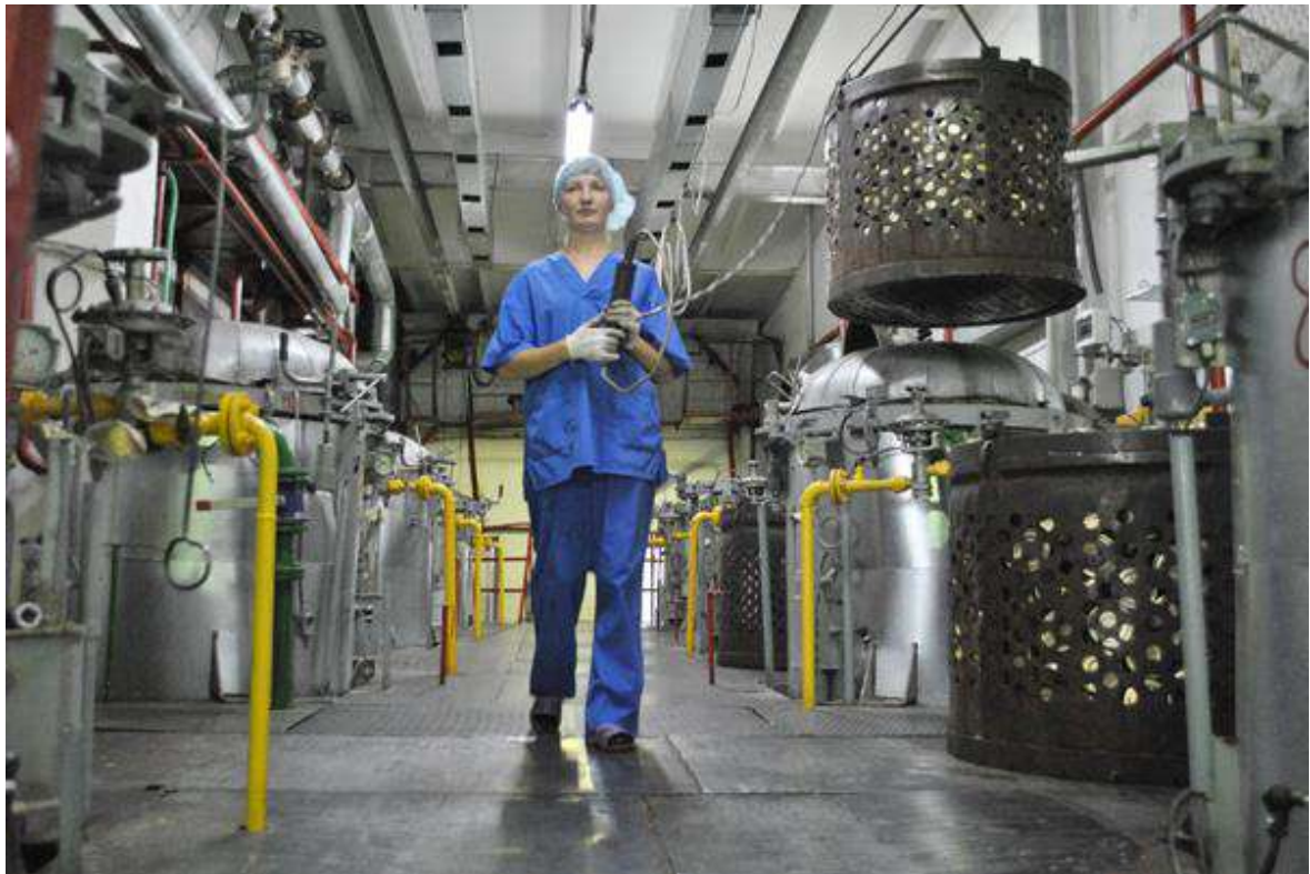
Рис. 23 – Загрузка в вертикальные вакуумные котлы корзин с консервами для стерилизации
